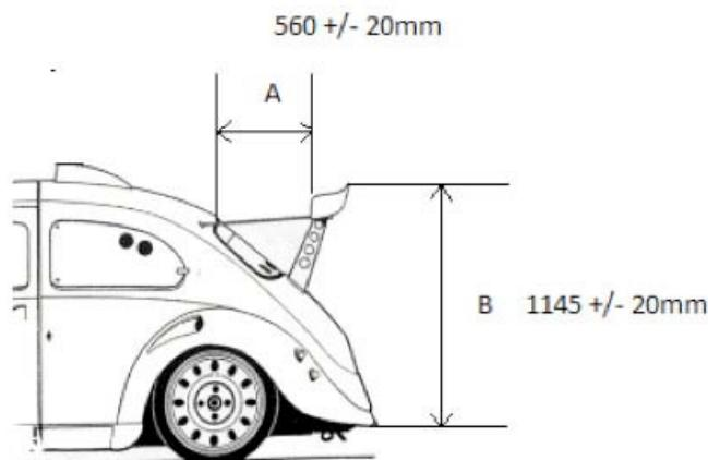
**3.1.7** Les différents éléments composant la carrosserie, notamment le spoiler avant qui doit être le modèle venant de chez M3 dénommé « spoiler évolution 1 » et version WRT, doivent être montés sur le véhicule pour les épreuves : essai(s) officiel(s) et course(s).
